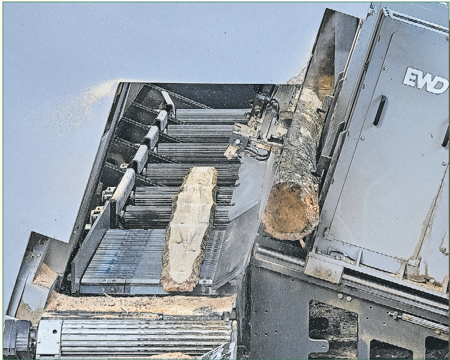
Aufteilung: Die neue Säge kann aus dem Rundholz verschiedene Teile schneiden, so auch eine solche Seitenbohle. Fotos: Schmalenbach
