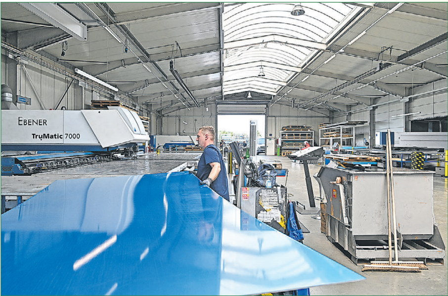
Material: Stanislaw Moor „füttert“ die Maschine, die Halterungen für die Alubleche ausstanzt und -schneidet.
