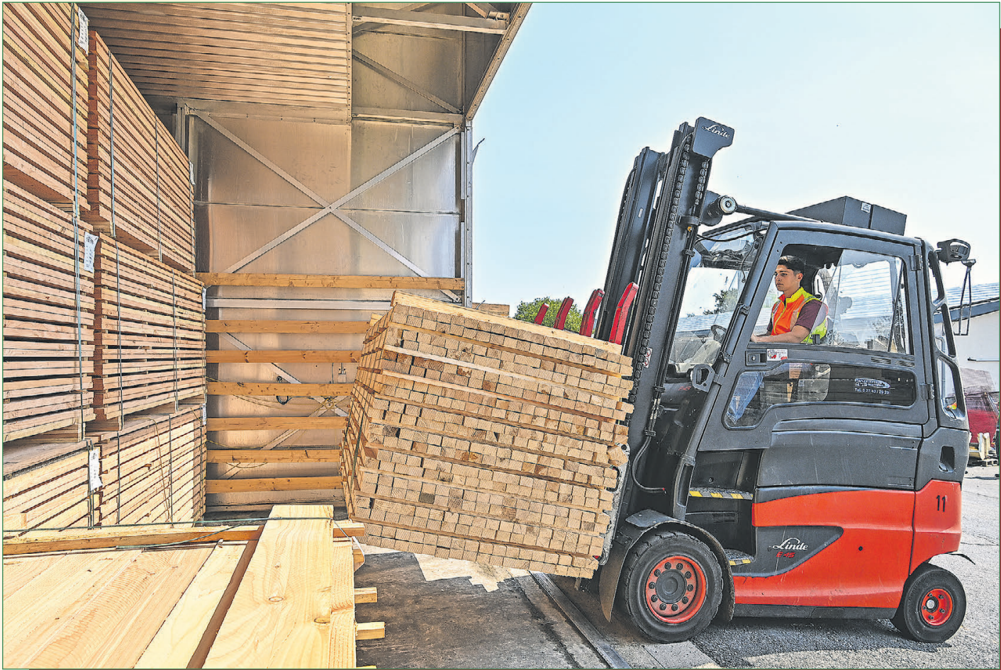
Aufwertung: In den eigenen Trockenkammern kann jedwedes Schnittholz vor der Auslieferung behandelt werden. Für Dachlatten, die Simon Weber hier in die Anlage fährt, darf die Restfeuchte anschließend 20 Prozent nicht überschreiten.
