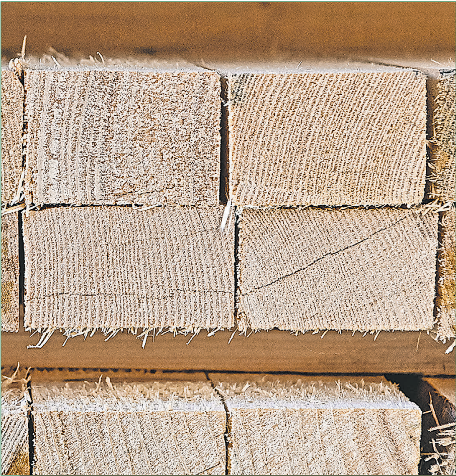
Stabilität: Die stehenden Jahresringe in den Latten sorgen für eine höhere Stabilität und reduzieren Veränderungen durch den Trocknungsprozess.
