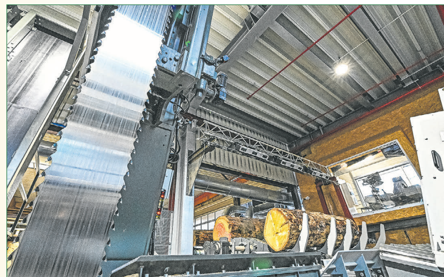
Säge: Die Stämme rollen unter der Stereoskopie hindurch, die sich in den drei schmalen Gehäusen an der Traverse befindet, auf den Sägewagen. Diese Optik prüft, ob die Lage der vorher berechneten entspricht.
