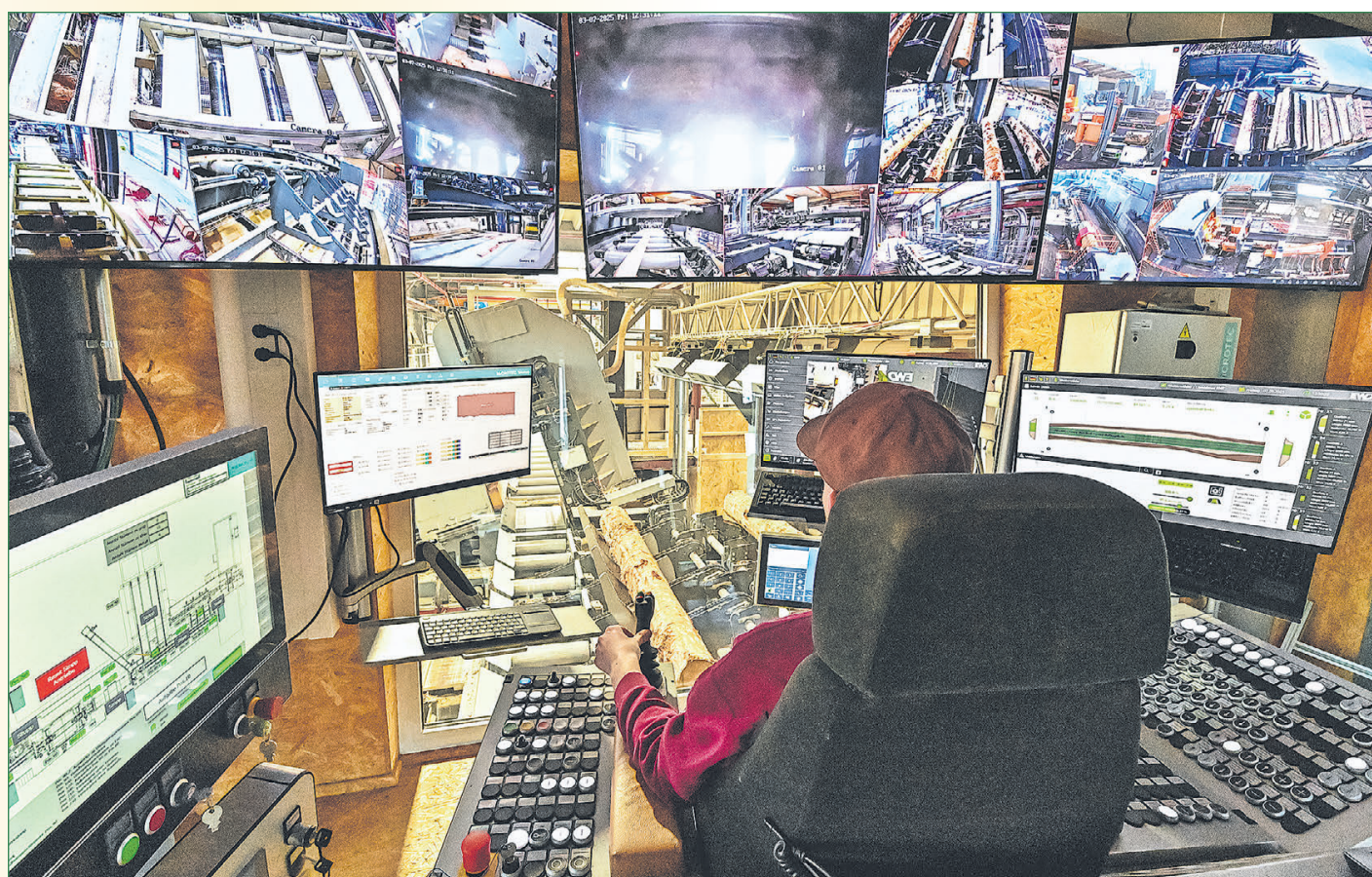
Bedienung: René bei der Arbeit, vor dem Sichtfenster dreht er gerade einen weiteren Stamm auf dem Sägewagen ein. Fotos: Schmalenbach
